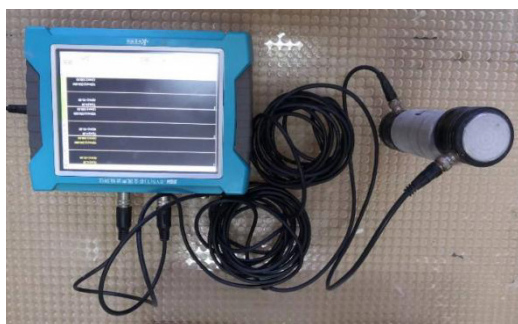
图 6 非金属声波测试仪 Fig.6 Non-metallic sonic tester
