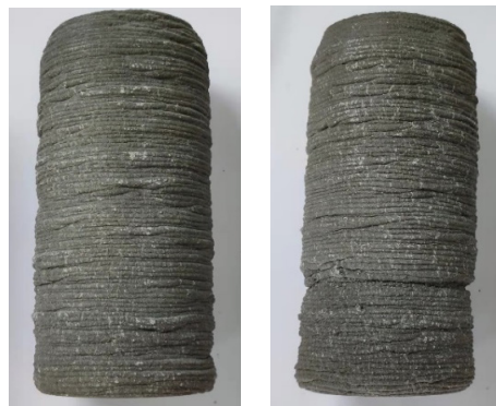
(a) 水泥基材料的 3D 打印试样
